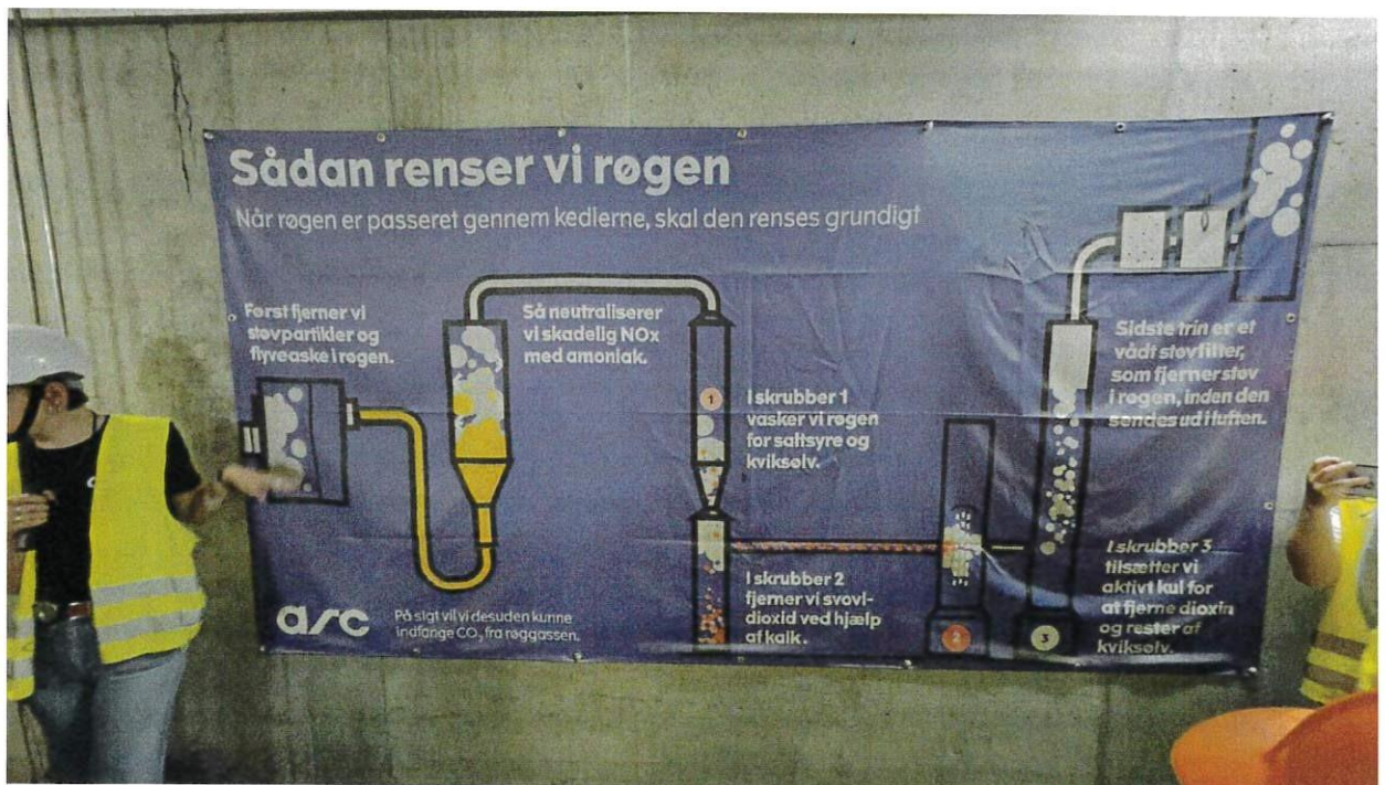
圖2-9 廢氣排放處理流程
